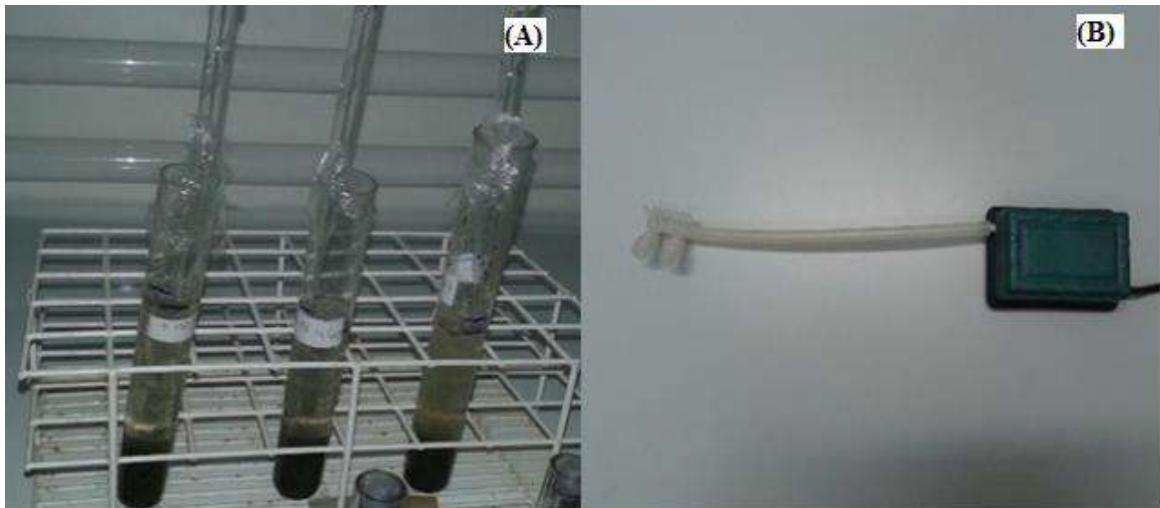
Figura 6: Organização do experimento de aeração no laboratório (A) e compressor de ar utilizado no mesmo (B).
